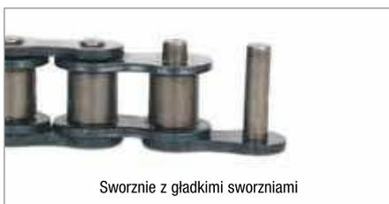
Warunkiem podziału łańcuchów ze sworzniami gładkimi jest zeszlifowanie główek nitów z jednej strony ogniwa zewnętrznego. Trzpień można potem wysunąć z łańcucha tak samo, jak podano wyżej, tzn. za pomocą jednego nacisku dźwigni.
