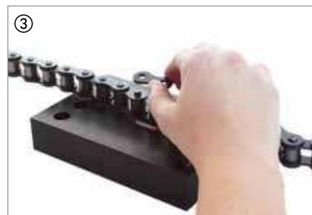
W przypadku łańcuchów ze sworzniemi osadzonymi i gładkimi postępujemy identycznie. Wkładamy nowy trzpień w oba końce łańcuchów, kładziemy łańcuch na płytkę do nitowania i wciskamy nową płytkę zewnętrzną na końce nitów trzpienia ③.
