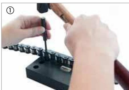
Wkładamy wystający sworzeń w odpowiednią tuleję w płytce do nitowania i wbijamy go młotkiem tak, aby nie wystawał nad powierzchnię. Następnie wybijamy bolec całkowicie za pomocą przebijaka ①.
