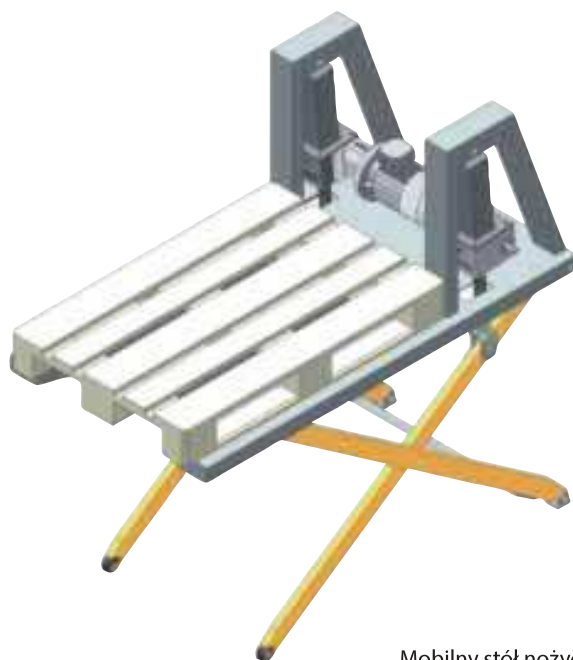
Mobilny stół nożycowy do przekazywania palet za pomocą wózka podnośnikowego
