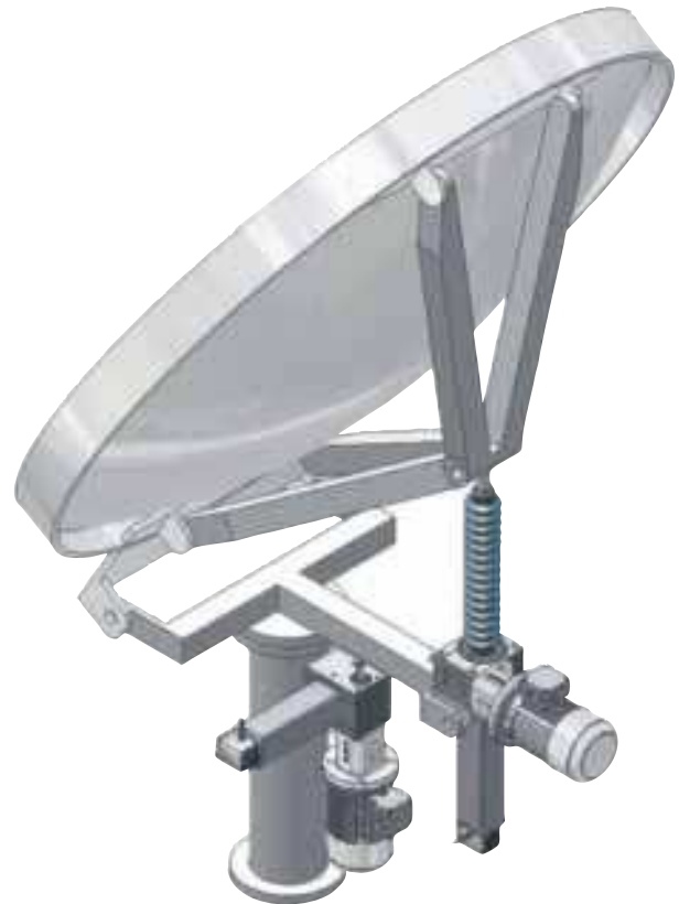
Antena paraboliczna D = 3,3 m, osie - pionowa i pozioma - każda po 50 kN, droga regulacji przypadająca na ruch 0,02 - 0,05 mm; urządzenia są zainstalowane na wolnym powietrzu na wybrzeżu morskim.
