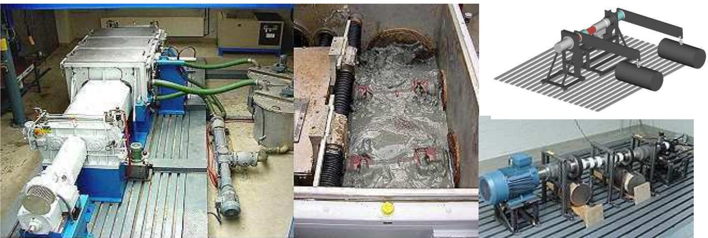
Stanowisko badawcze do wykonywania symulacji eksploatacji w trudnych warunkach. Zadany zostaje moment obrotowy, obroty i pochylenie wału. Praca w szlamie lub bez, sterowanie badań i testów eksploatacyjnych odbywa się przez specjalny program.
